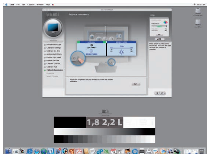
Slika 31. Pri kalibraciji svetlosti se morata izenačiti zelena in dosežena svetilnost zaslona v cd/m 2 .
