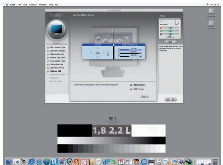
Slika 30. Kalibracija barvne temperature. Glede na vrsto monitorja izberemo privzete nastavitve RGB ali ročno nastavljanje (RGB controls), da bi dosegli zeleno barvno temperaturo. Program prikaže tudi zeleno in izmerjeno svetilnost zaslona.
