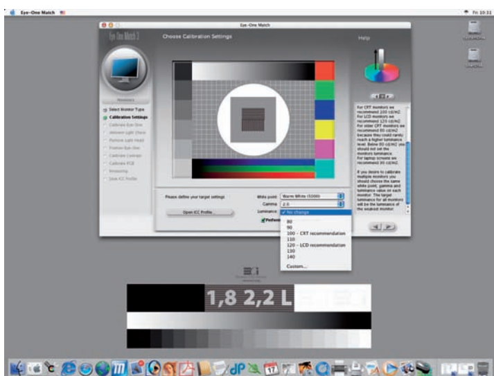
Slika 24. Svetilnost (luminance) ostane naravna, če želimo monitor zgolj profilirati, sicer za monitorje CRT priporočajo 100, za LCD pa 120 cd/m 2 . Mnogi starejši monitorji ne dosežejo več kot 80, notesniki ne več kot 90 cd/m 2 . V takih primerih moramo izbrati na vseh monitorjih v skupini svetilnost najšibkejšega in poskrbimo, da so tudi barvne temperature in gradacije na vseh enake.
