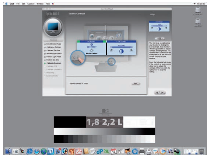
Slika 29. Kalibracija kontrasta. Če monitor tega ne omogoča, jo preskočimo.
