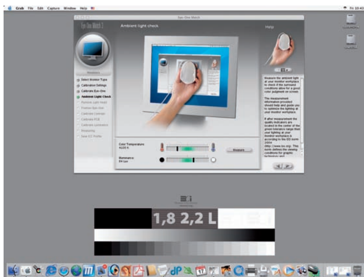
Slika 27. S fotometričnim vrednotenjem ugotovimo, ali so svetlobne razmere v prostoru primerne za primerjanje barv in ali bi jih morali optimizirati po standardu SIST ISO 3664, ki velja za grafično dejavnost in fotografijo.
