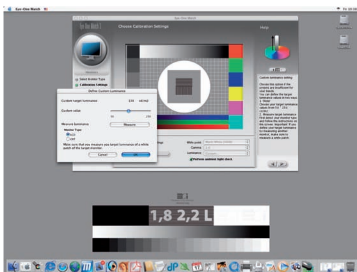
Slika 25. Svetlost zaslona lahko nastavimo po svojih potrebah, denimo tako, da ustreza svetlosti kakšnega drugega monitorja. Tam jo na belem polju izmerimo s spektrofotometrom (Spectrolino, Color-Eye Display 2). Praksa kaže, da so monitorji LCD ob priporočeni svetilnosti 120 cd/m 2 presvetli in je bolje nastaviti 100–110 cd/m 2 .
