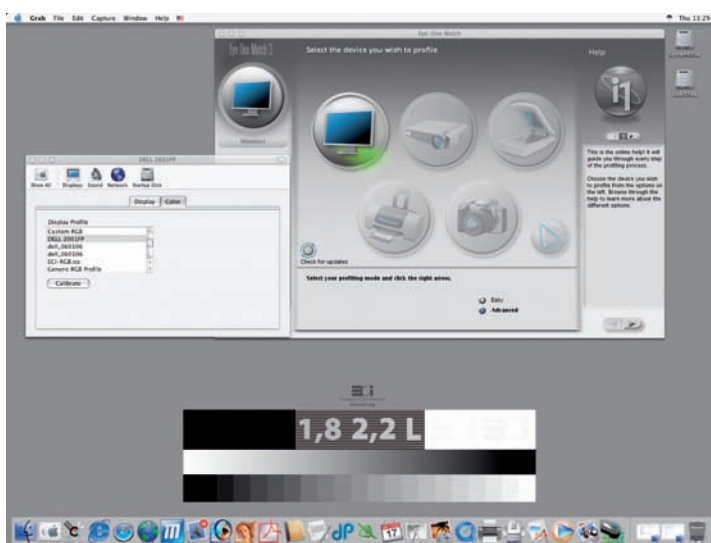
Slika 18. Preden začnemo kalibrirati, moramo v operacijskem sistemu nastaviti 32-bitni barvni prostor (barvno globino), da računalnik na zaslonu upodobi 16,7 milijona barv, primerno ločljivost, ki mora pri monitorjih LCD ustrezati zasloni, in generični ali privzet barvni profil RGB za dani tip monitorja. V programu Eye-One Match 3.6 nato izberemo način kalibracije. Ker vemo, kaj hočemo narediti, se odločimo za »Advanced«.
