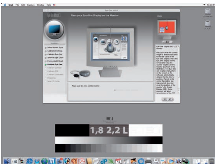
Slika 28. Kalibracija poteka v treh korakih: najprej kontrast, potem barvna temperatura in končno svetlost. Spektrofotometer smemo postaviti kamor koli, kajti program sam prepozna njegovo pozicijo. Vseeno je najbolje, da je v sredini zaslona ali tam, kjer najpogosteje opazujemo slike.
