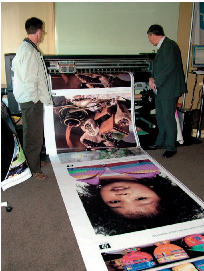
Tisk panojev na širokoformatnem tiskalniku Designjet 9000s s solventnimi tiskarskimi barvami. Tiskovni material mora biti prirejen, ker ga tiskalnik pred in med tiskom segreva, da se poveča vpijanje in adhezivnost tiskarske barve. Ko se po tisku ohladi, zakrjne in dobimo zelo površinsko trden in trajen odtis.
