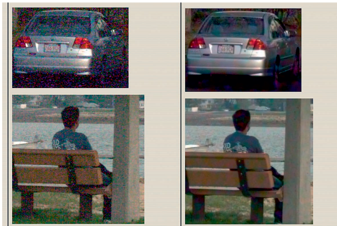
Slika 4. Uspešnost nove zasnove snemalnega vezja je Gang Luo dokazoval s simulacijo na podlagi podosvetljenih surovih posnetkov (slikovni format RAW), ki jih je izdelal z digitalnim fotoaparatom Canon 30D. Ta ima na snemalnem vezju formata APS-C (22,5 × 15,0 mm) po Bayerjevem načelu razporejenih 8,5 milijona fotoelementov. Pri tej razporeditvi se pojavi močan slikovni šum (levo), pri Luovi izgine, izboljša pa se tudi upodabljanje podrobnosti (desno).
