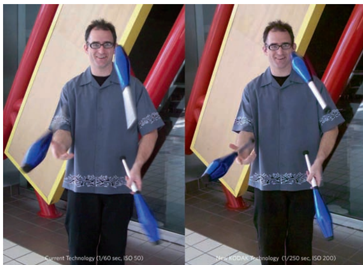
Slika 7. Nova struktura snemalnega vezja (CFA) povzroča v slabih svetlobnih razmerah veliko manj slikovnega šuma kot Bayerjeva. Izboljšuje tudi učinkovitost digitalne kamere pri akcijski fotografiji. Slike niso simulacija, marveč eksperimentalni posnetki s praviimi snemalnimi vezji (zagotovilo Kodaka).
