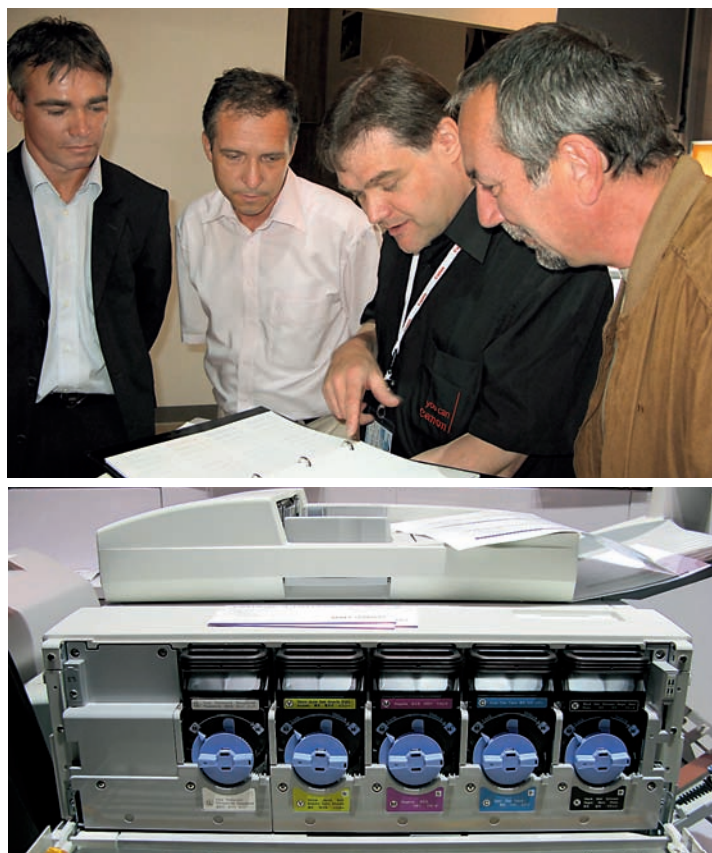
Slika 8. Predstavitel laserskega stroja Canon imagePRESS C1+ na Drupi 2008. Štiri plus ena kartuša za procesne barve in dodatni transparentni toner.
