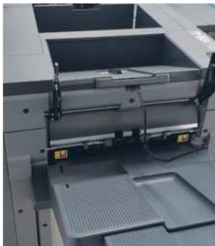
Konica Minolta C4070 s funkcijami tiska in dodelave na SŠOM. Omogoča različne funkcije: znašanje, zgibanje in obrezovanje.
